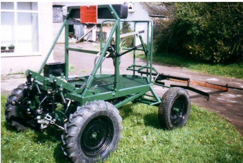
Avant-train à 4 roues avec un relevage hydraulique 3 points et prise de force entraînée par l'essieu arrière à 540 tours/mn.
