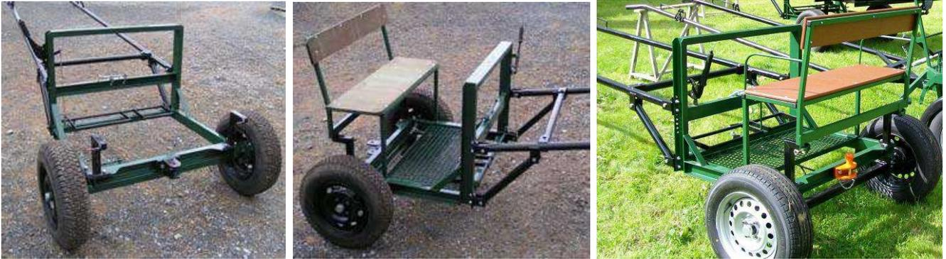
Largeur : 1,50m - Roues pneumatiques en 14" - Poids total : environ 200 kg
