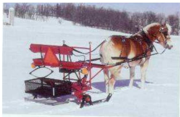
**Forecart** équipé avec siège de travail, roues pneumatiques, timon, freins mécaniques et lame de déneigement.
