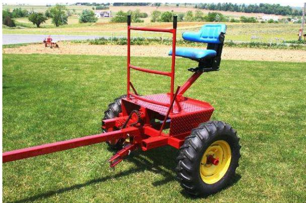
**IJ 07 : Avant train avec prise de force entraînée par les roues.**
