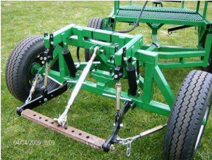
Relevage arrière hydraulique 3 points, entraîné par une pompe manuelle ou électrique.
