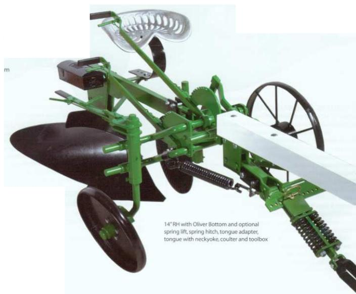
Conçue pour ses performances et sa fiabilité, cette "charrue-sulky" permet de réaliser un excellent travail de labour quelque soit la nature du terrain. Toutes les poignées de réglages et de commandes sont facilement accessibles depuis le siège. La largeur et la profondeur du sillon sont réglables avec une large plage.
