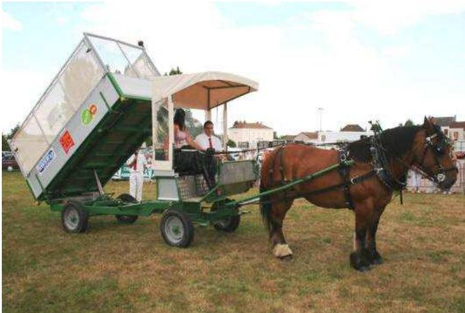
L'équibenne, avec un poids à vide de 840 kg, dispose de 2 tonnes de charge utile.
