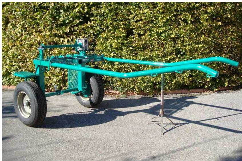
Utilisable en simple ou en paire, Cet avant-train de débardage peut également être utilisé en trinqueballe, ou en avant-train classique avec point d'attelage boule/cheville.
