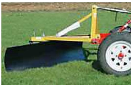
**IJ 11 : Lame arrière, orientable sur fixation 3 points**
