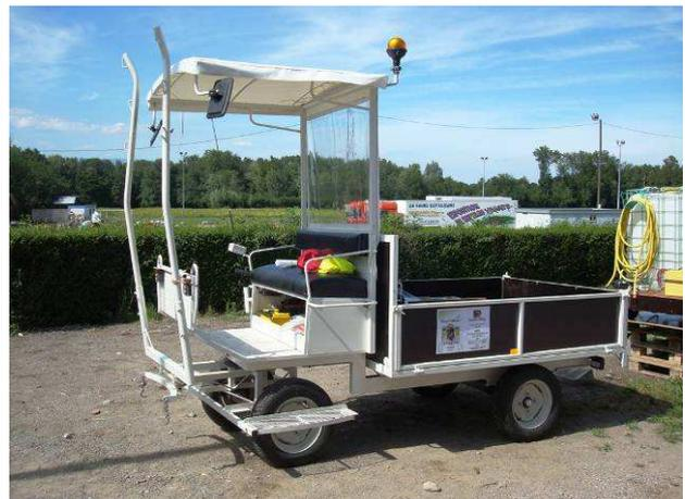
Poids à vide de 600 kg - 900kg de charge utile - caisse de 2m x 1,50m.
