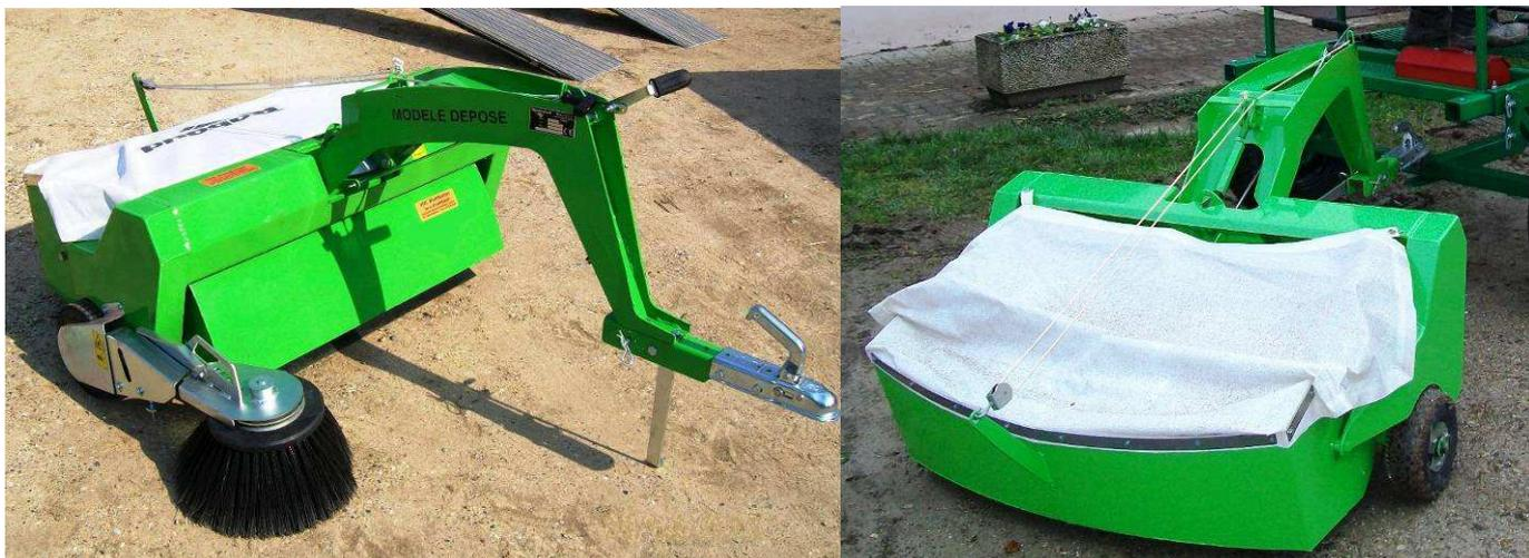
Tractable derrière un avant-train avec attelage par boule Ø 5 cm.
