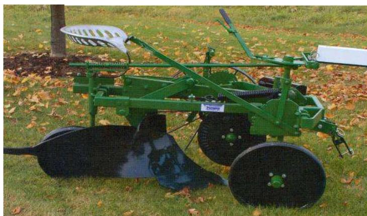
Ce modèle dispose d'une pédale permettant de relever le soc lors des manœuvres en bout de rangée.
