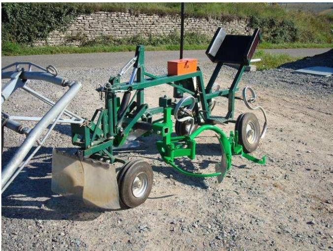
Spécialement conçu pour le travail de la terre dans les vignes, pépinières, cultures maraîchères et autres plantations en ligne, ce porte-outil, conçu sur un châssis à 4 roues, tracté par un seul cheval permet d'utiliser les outils standard tels que griffes, sarcleuses, décavaillonneuses, disques, semoir à herbe, tondeuse thermique, inter-ceps, scarificateur, ...
