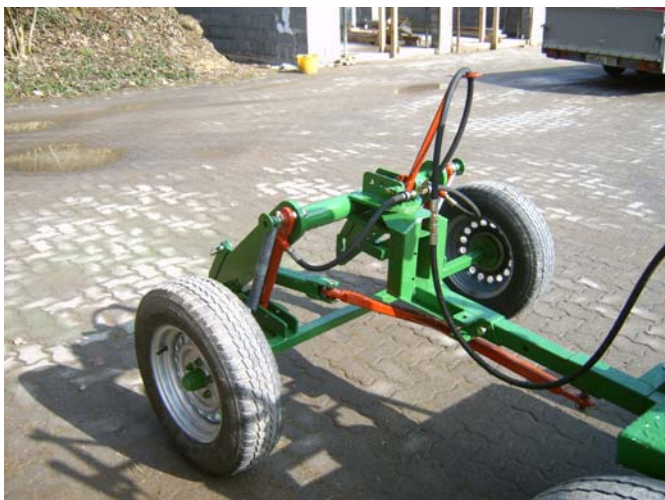
Dreipunktadapter fährt spurtreu dem Vorderwagen nach, dadurch sind enge Wendungen möglich
