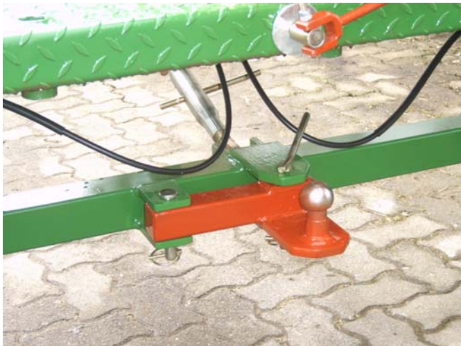
Die wahlweise Kugelkopfkupplung wird mit 2 Bolzen befestigt
