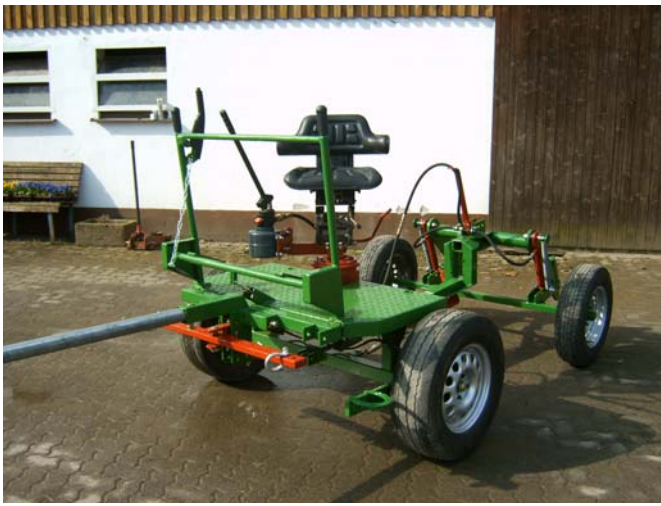
Vorderwagen mit angehängtem Dreipunkt-Adapter in zweispänniger Ausführung
