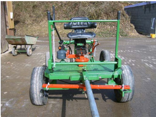
Frontansicht des Vorderwagens mit abnehmbarer Handhydraulikpumpe
