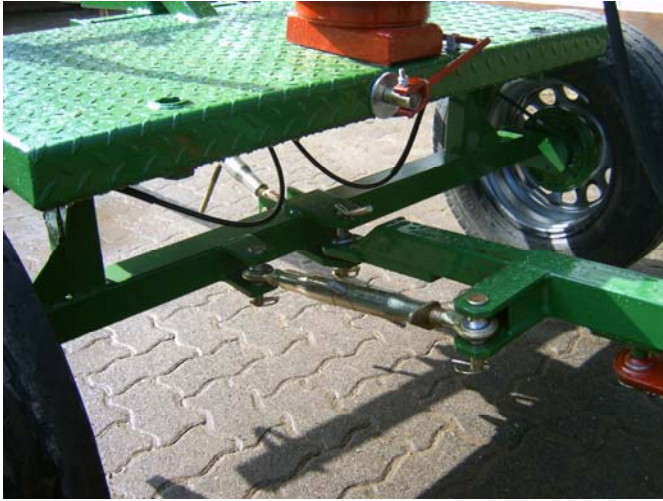
Maulanhängekupplung mit angehängtem Dreipunktadapter
