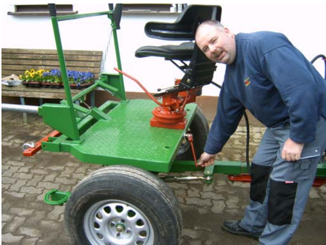
Stufenlose Verstellung der gesamten Fahrerplattform mittels Handkurbel
