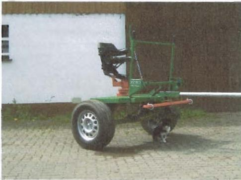
Vorderwagen Grundausrüstung mit Spielwaage, Querdeichsel, Drehsitz, Bremse und gebrauchten Reifen:
