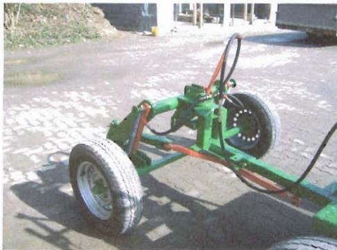
Geräteträger in Grundausrüstung mit gebrauchten Reifen und Nachlenkung:
