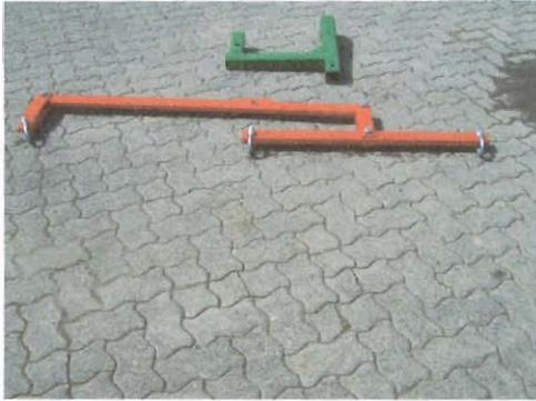
Dreispannerausrüstung, bestehend aus Dreispännerwaage und Deichseladapter:
