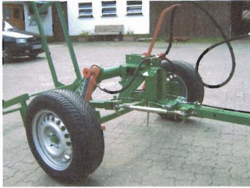
Geräteträger mit Bremsachse:
