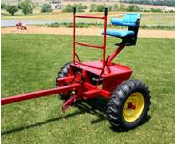
**IJ 07 : Avant train avec prise de force entraînée par les roues.**
