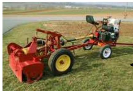
**IJ 09 : Second essieu avec relevage hydraulique 3 points**
