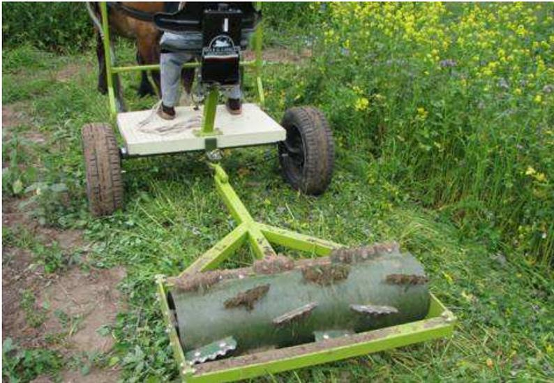
Ce rouleau à couteaux a été développé pour précéder, en présence d'engrais vert, le labourage. Sa fonction est d'abattre la biomasse et de la broyer afin de l'enfourir aisément.
