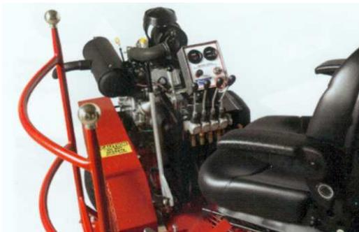
Toutes les commandes (embrayage de la prise de force, distributeurs hydrauliques, pédales de freins, compteur d'heures, voltmètre) sont facilement accessibles depuis son siège par l'opérateur.
