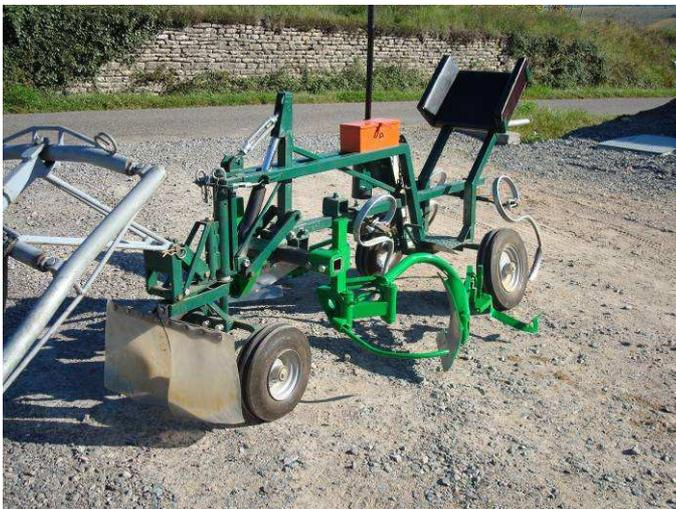
Spécialement conçu pour le travail de la terre dans les vignes, pépinières, cultures maraîchères et autres plantations en ligne, ce porte-outil, conçu sur un châssis à 4 roues, tracté par un seul cheval permet d'utiliser les outils standard tels que griffes, sarcluses, décavillonneuses, disques, semoir à herbe, tondeuse thermique, inter-ceps, scarificatuer, ...
