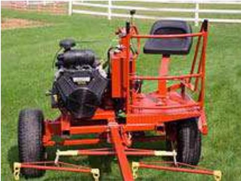
**IJ 10 : Avant-train avec moteur auxiliaire**
