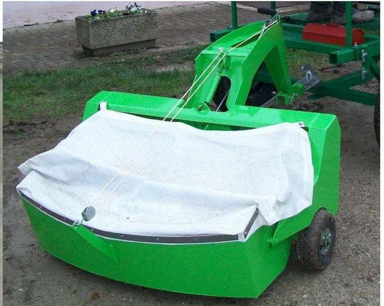
Tractable derrière un avant-train avec attelage par boule  $\varnothing$  5 cm.
