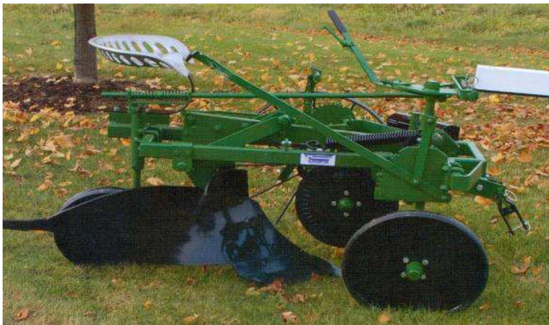
Ce modèle dispose d'une pédale permettant de relever le soc lors des manœuvres en bout de rangée.
