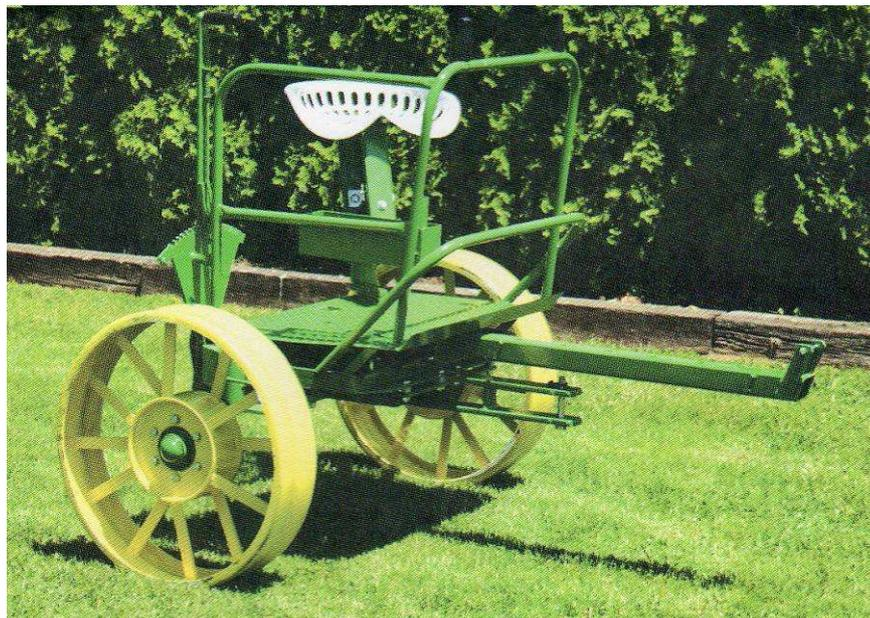
Cet avant-train dispose d'un levier permettant d'orienter les roues avec précision.
