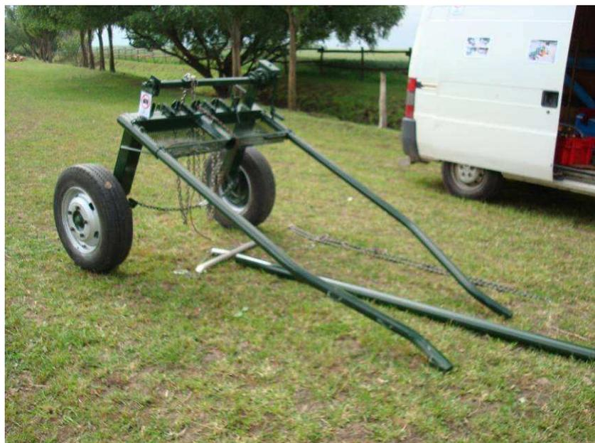
Utilisable en simple ou en paire, Cet avant-train de débardage peut également être utilisé en trinqueballe, ou en avant-train classique avec point d'attelage classique avec point d'attelage boule/cheville.
